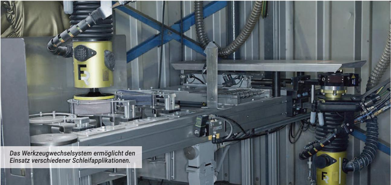
Das Werkzeugwechselsystem ermöglicht den Einsatz verschiedener Schleifapplikationen.
