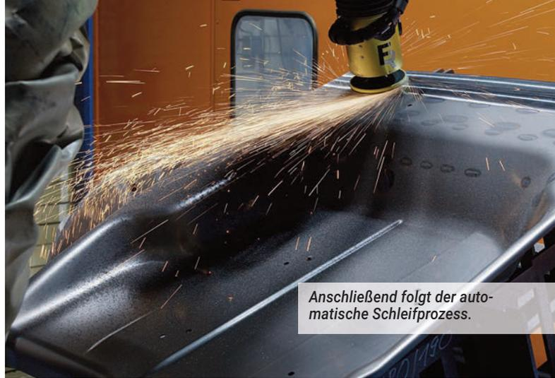
*Anschließend folgt der automatische Schleifprozess.*
